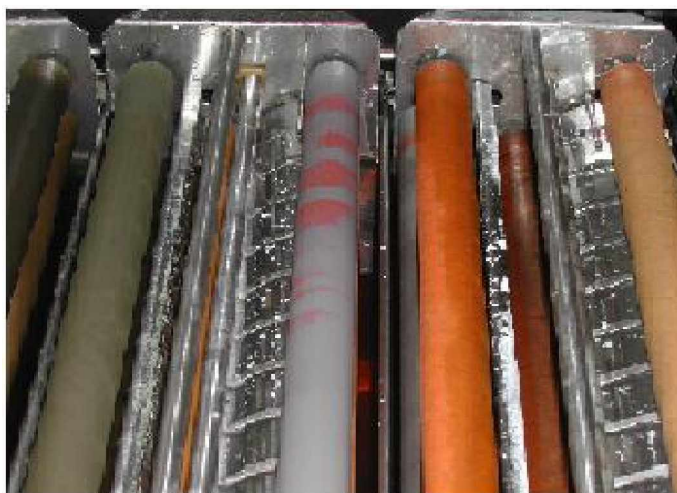
Figura 4.4. Rolos da processadora do hospital B com diversas manchas.
